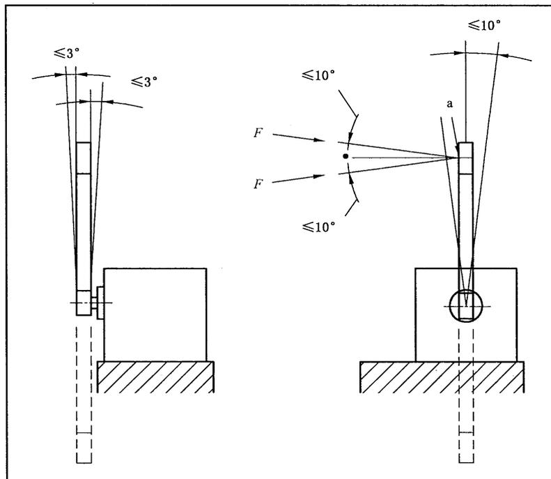
图2 扭矩扳子处于垂直试验状态
