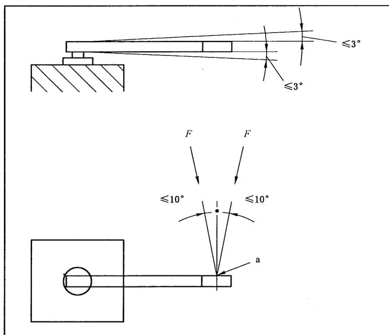
图1 扭矩扳子处于水平试验状态
